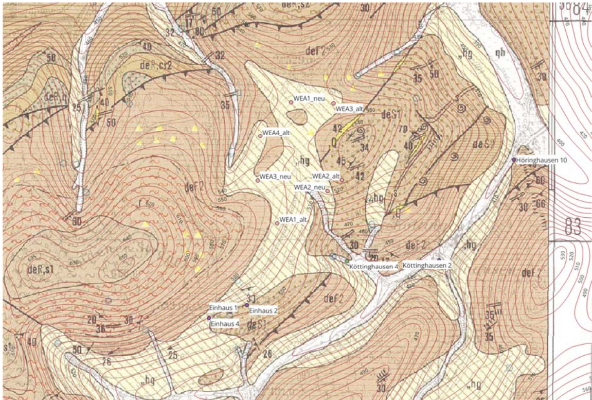
Bild 2: Geologische Karte (gk 4715) des Untersuchungsgebiets mit den Standorten der Windenergieanlagen und den Unterliegern sowie den aktuellen Höhenlinien der TK 25.
